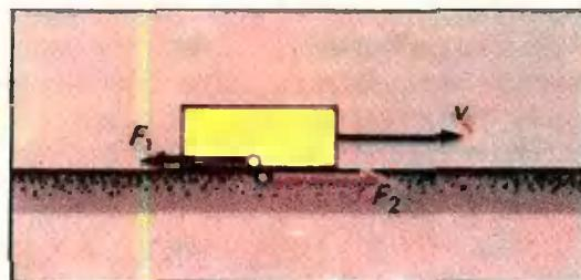
Рис. 2. Сила трения  $F_1$ , действующая на тело, совершает работу, а сила трения  $F_2$ , действующая на неподвижную опору, работы не совершает.
