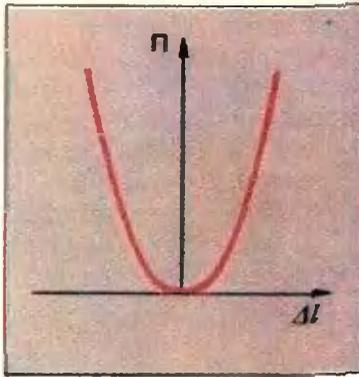
Рис. 4. Зависимость потенциальной энергии пружины  $P$  от деформации  $\Delta l$ .
