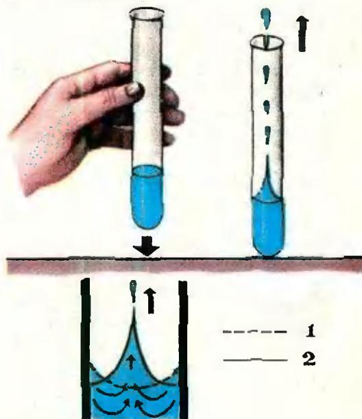
Всплеск воды в падающей пробирке. Пунктир 1 — форма поверхности воды до удара, сплошная линия 2 — сразу после удара.
