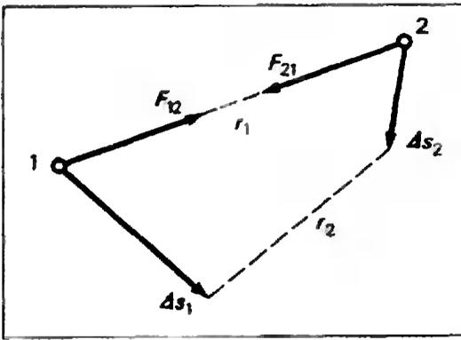
Рис. 3. Изменение потенциальной энергии взаимодействия тел 1 и 2 определяется работой сил  $F_{12}$  и  $F_{21}$  на перемещениях  $\Delta s_1$  и  $\Delta s_2$ .
